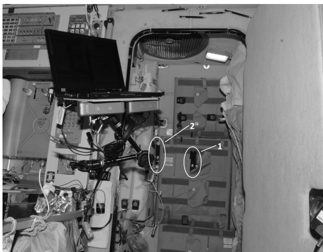
Рис. 1. Размещение детекторов НА «Баббл-дозиметр» на укладке «Шторка защитная»: 1 – размещение детектора на поверхности укладки со стороны каюты; 2 – размещение детектора на незащищенной панели рядом с укладкой. Спектрометрические детекторы находятся на внешней стороне укладки (между укладкой и иллюминатором)
