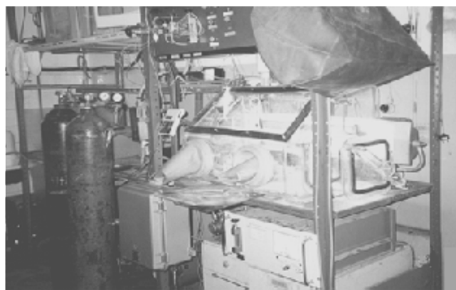
Рис. 1. Внешний вид экспериментального стенда для кратковременных исследований на животных в газовой среде произвольного состава
