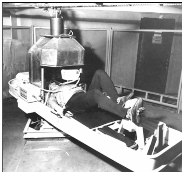
Рис. 4. ЦКР ИМБП 1-го поколения: радиус – 1,7 м; 1 ложемент с расположением 1 испытуемого только в горизонтальном положении; максимальная величина перегрузок + 2 Gz на уровне стоп; ось вращения – на уровне переносицы; отсутствие кабины
