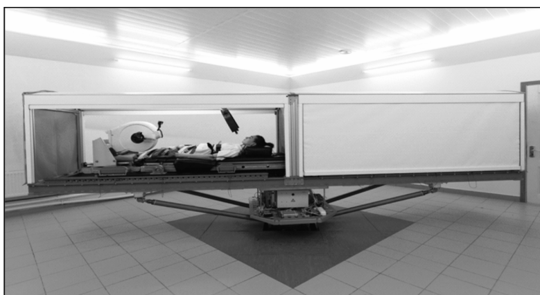
Рис. 1. Положение испытуемой на консоли ложемента ЦКР до начала воздействия перегрузок «голова – таз»
