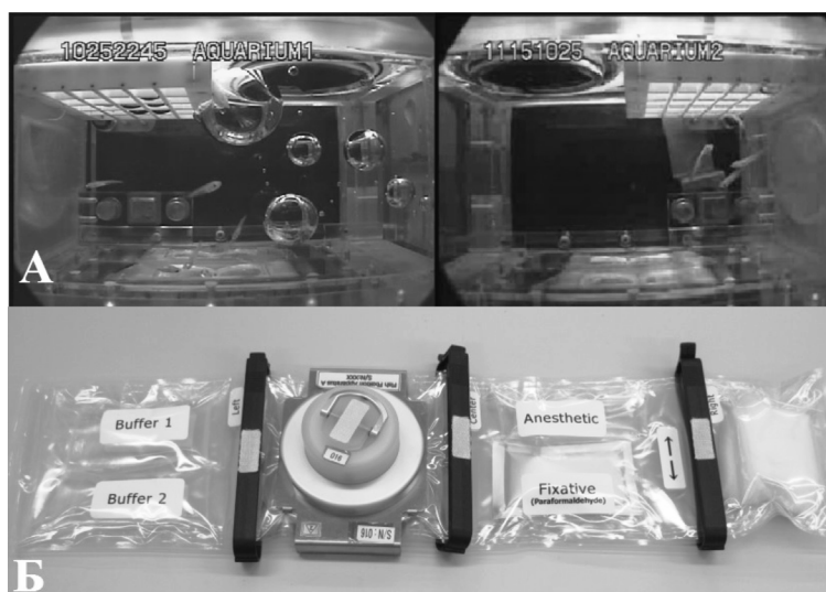
Рис. 1. А – рыбы Danio rerio в аквариуме на борту МКС; Б – устройство для фиксации рыб на борту МКС
