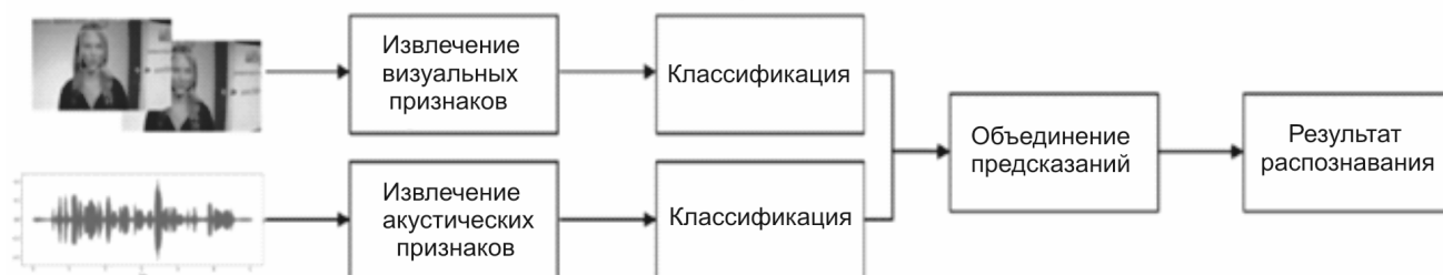
Рисунок. Этапы распознавания состояний обследуемого в сеансе телекоммуникации на примере обработки аудио- и видеоданных (из работы [66])
