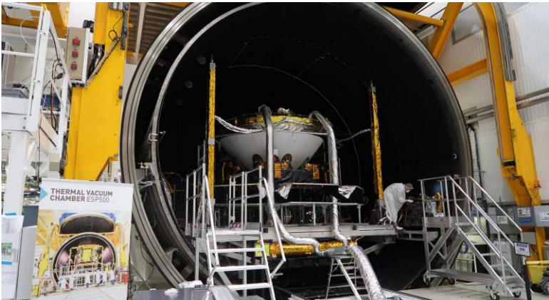
Рис. 3. Испытание посадочного аппарата в термовакuumной камере
