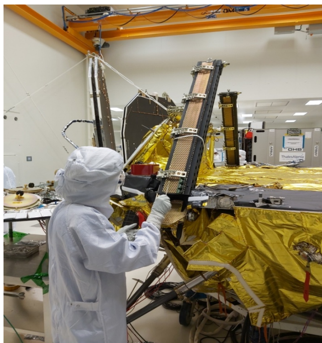
Рис. 1. Отбор тампоном микробиологических проб с элементов ДМ
