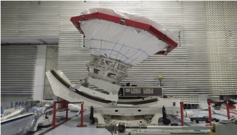
Рис. 4. Испытание посадочного аппарата в чехле на балансировочном стенде
