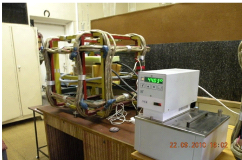
Рис. 1. Получение пространства с гипомангнитной средой с использованием колец Гельмгольца
